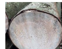
Bois bleu, impropre charpente
