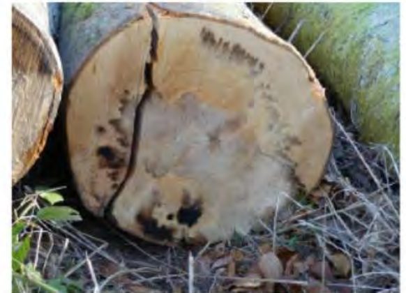
Photo 1 : Grume présentant un cœur rouge excentré et dissymétrique ainsi que des tâches noires sur la périphérie.
